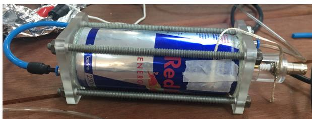
**Figura 3:** Contador proporcional construído a partir de uma lata de alumínio.
